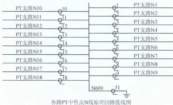
图5 各路PT中性点N线回路接线图
